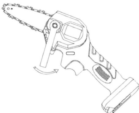
1. Standardní nastavení spočívá v ručním zvednutí řetězu uprostřed desky lišty a odhalení 1-3 středních vodicích zubů.
