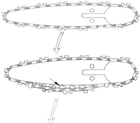
3. Nový řetěz se v počáteční fázi používání roztáhne. Často kontrolujte napnutí a odpovídajícím způsobem jej seřidte, protože uvolněný řetěz snadno spadne, což může vést k rychlému opotřebení řetězu a vodicí desky.
